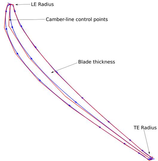
**Figure 5.** Section parameters
